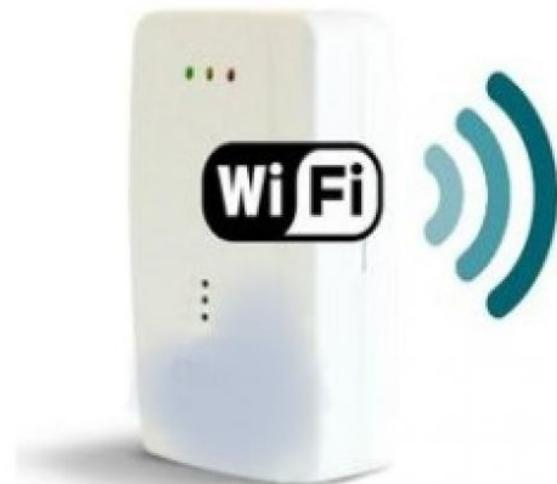
ZONT H-2 - это термостат для электрических и газовых отопительных котлов. Дистанционное управление работой терmostата осуществляется по сети Wi-Fi .
