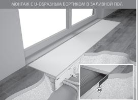
Не допускайте, чтобы корпус конвектора испытывал нагрузки со стороны пола. Может произойти деформация установочного уголка решетки и повреждения решетки. При использовании расширяющихся половых покрытий, например, паркета, а также системы "теплый пол", необходимо устанавливать в месте стыка рамки конвектора с половым покрытием компенсационные швы, например пробковую, либо резиновую полосу (3).
