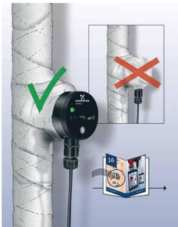
Рис. 5 Изоляция корпуса насоса
