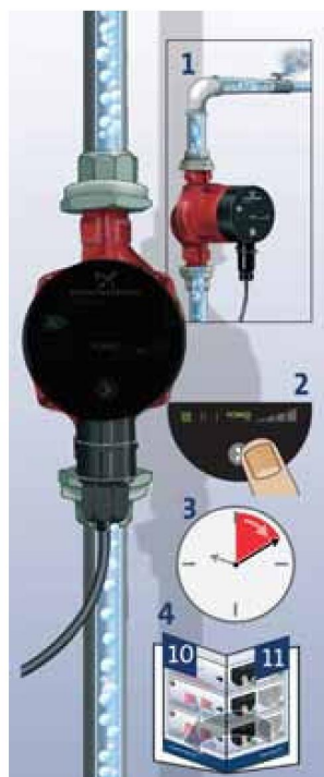
Рис. 12 Удаление воздуха из систем отопления
