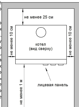
Рис. 4 – Схема установки котла
