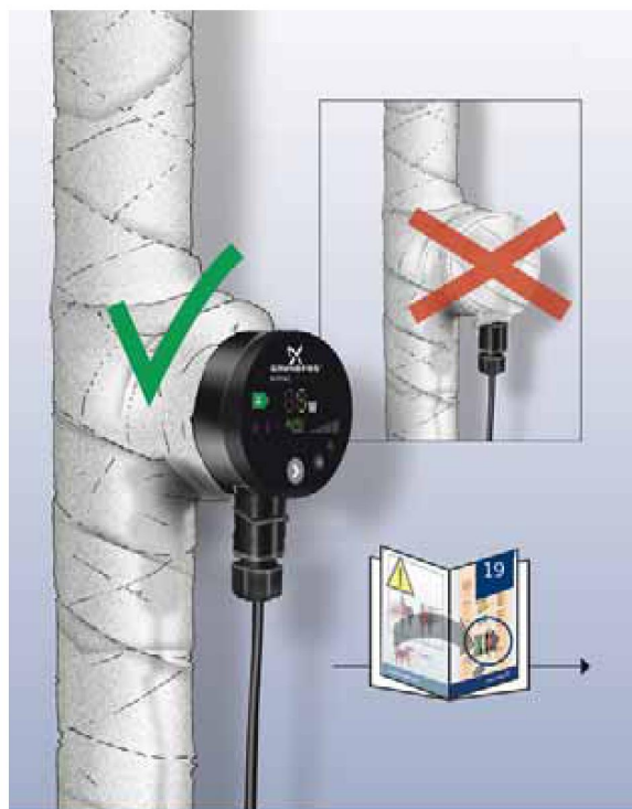
Рис. 5 Изоляция корпуса насоса
