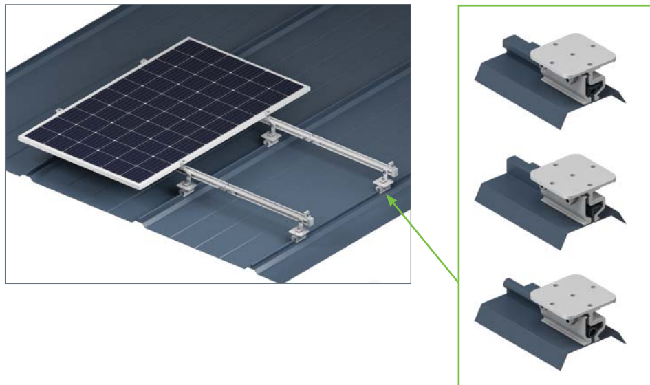
Рисунок 3.3.5 Способ крепления к фальцевой кровле
