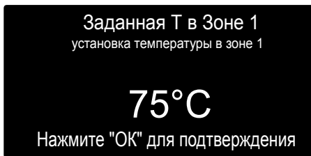
Изменение температуры горячей воды отопления
