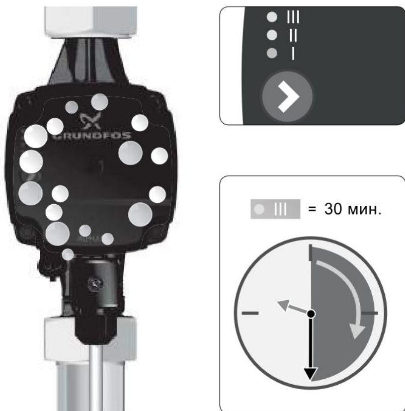
Рис. 10 Удаление воздуха из насоса
