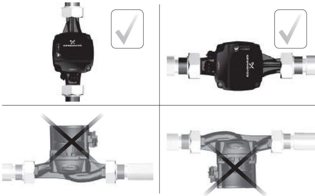
Рис. 4 Примеры размещения насоса
