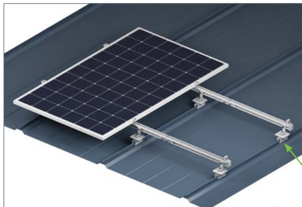
Рисунок 3.3.4 Способ крепления ФЭМ на фальцевую кровлю
