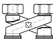
Перекрестие применяется в качестве соединителя между клапаном и трубопроводом для подгонки расстояния между трубами или положения отопительного прибора относительно труб.
