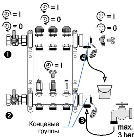
Закройте шаровые краны **1+2**. Подключите шланг для наполнения и промывки к сливному крану концевой группы **3** подающего патрубка; сливной кран **4** обратного патрубка должен быть полностью открыт!
