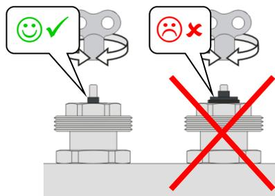
Мелкая резьба регулирующего шпинделя не должна выступать выше шестигранника SW19! Для полного открытия клапан из полностью закрытого состояния необходимо 2,5 - 3 оборота шпинделя против часовой стрелки (максимальный расход).
