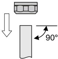
Разрежьте пластиковую, медную или металлопластиковую трубу под прямым углом, зачистите и откалибруйте ее. Наденьте накладную гайку фитинга на трубу.
