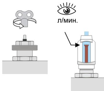
Необходимый расход теплоносителя устанавливается поворотом регулировочного шпинделя против часовой стрелки. Фактическая величина расхода теплоносителя контролируется по показаниям расходомера.
