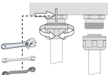
Удерживая гайку на выходе коллектора гаечным ключом SW24, закрутите накладную гайку ключом SW 30 (момент затяжки 25-30Нм). Максимально допустимый момент затяжки применяемых компрессионных фитингов не должен быть ниже указанных значений.
