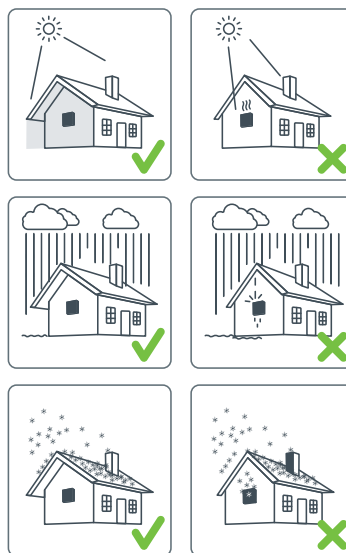
Рисунок 3.4.2 Установка инвертора на поверхность
